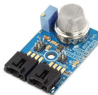
Fig 2.7.1: MQ131 Ozone Sensor [1]
