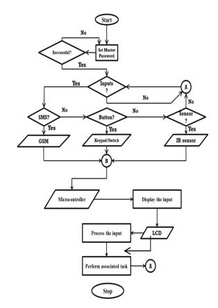
Fig. 13. Data Flow Diagram
